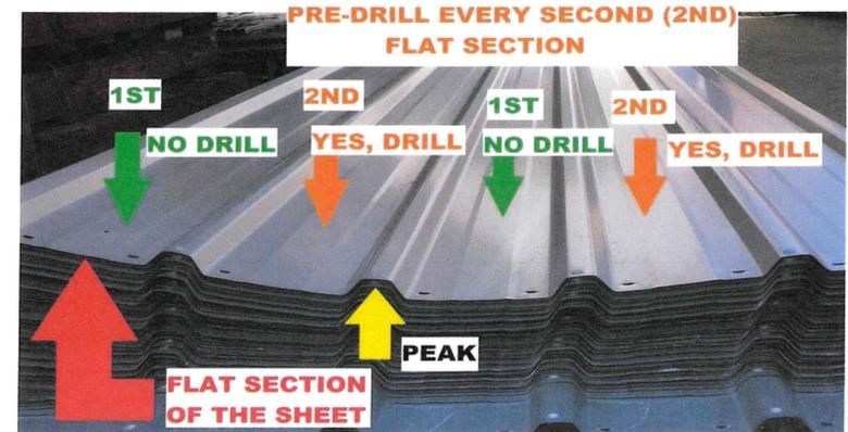
木製フレームと本体鉄パネルの緊結箇所は上図のごとく鉄パネル接合部から2山あるいは4山部分とする。木製フレームのタル木位置が整合しない場合はタル木の位置を移動しても良い。ただし 積雪地域ではタル木相互間の距離を慎重に検討すること。
